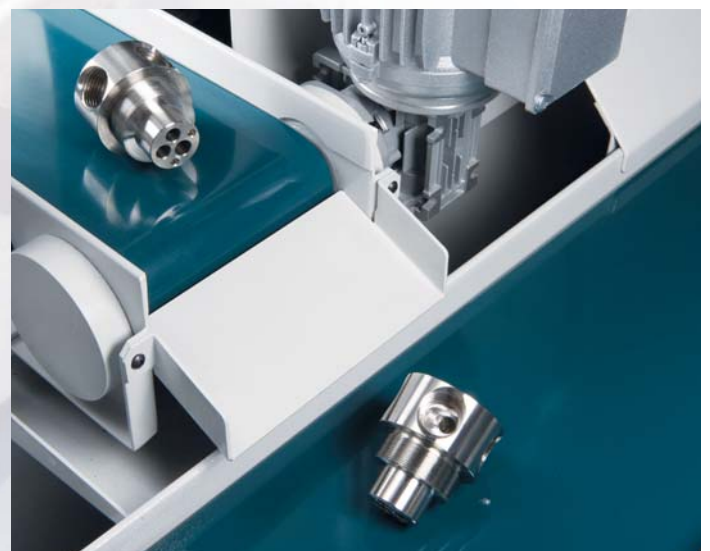
SCARICATORE LATO CONTROMANDRINO
